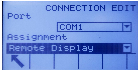
Figura 3-11: Connessione COM1 configurata per display remoto
