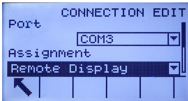
Figura 3-13: Connessione COM2/COM3 configurata per il funzionamento remoto
