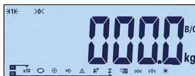
**Figura 3-27: Display após Limpeza Automática de Tara**
