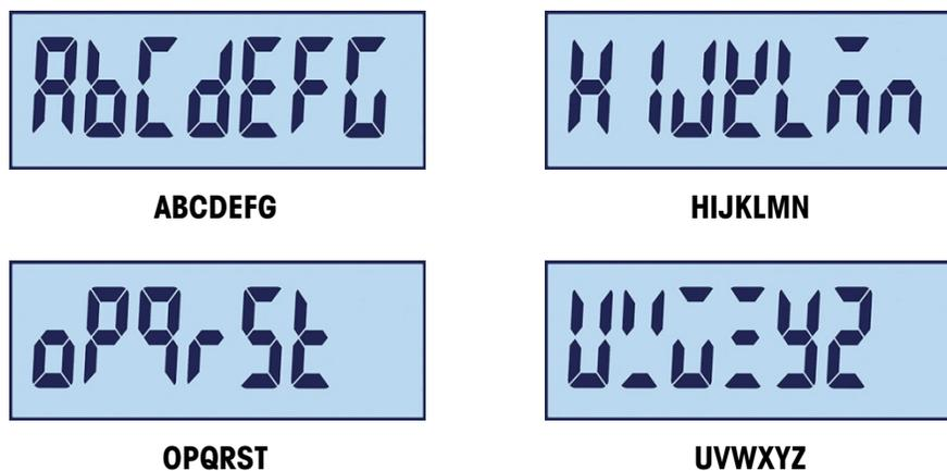
**Figura 2-2: Display LCD Segmentado de Caracteres Alfabéticos**
