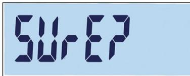
**Figura 3-61 Aviso de Confirmação de Redefinição de Bloco de Terminal**
