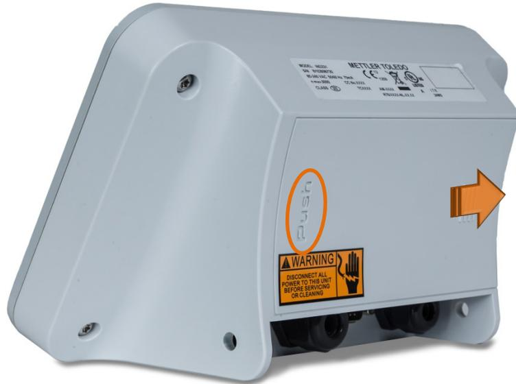
**Figura 4-1: Removendo a Tampa da Bateria**
