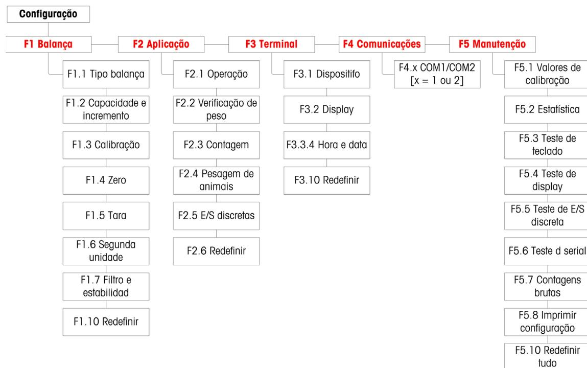
Figura 3-7: Estrutura de Menu de Configuração de IND231/IND236
