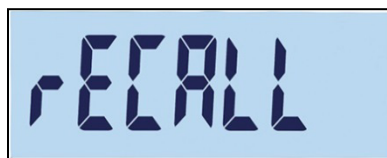
Figura 2-14: Messaggio di richiamo del database target
