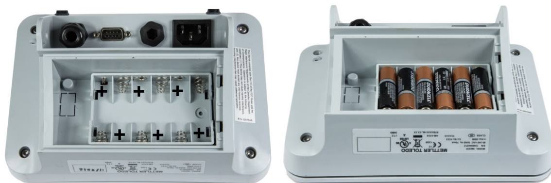
Figura 4-2: Porta batterie AA per IND231 vuoto (a sinistra) e con batterie (a destra)
