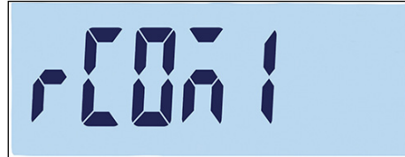
Figura 2-8: Impostazione del tipo di bilancia per il funzionamento remoto
