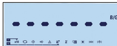
Figura 2-22: Display che indica l'acquisizione del valore di pesa in corso
