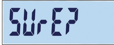
Figura 3-74: Richiesta di conferma di ripristino generale
