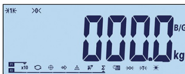
Figura 3-27: Display dopo la cancellazione automatica della tara
