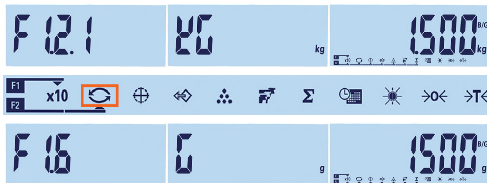
Figura 2-7: Cambio unità di misura: Da chilogrammi a grammi
