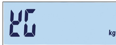
Figura 3-28: Schermata di impostazione delle unità primarie
