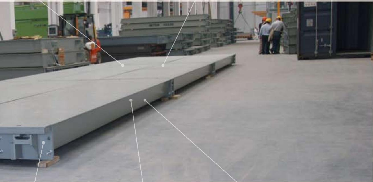
**Faible hauteur** – garantit que les conducteurs peuvent facilement monter sur le pont bascule s'il est hors-sol.
