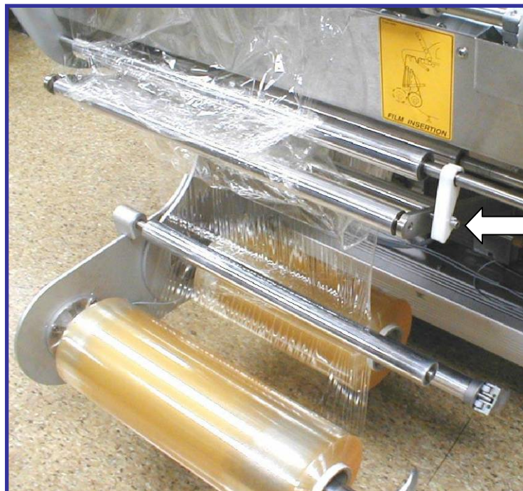
Barra de soltura mostrada en posición bloqueada
