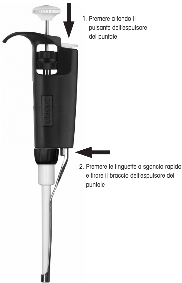
Figura 5: Rimozione del braccio espulsore del puntale
