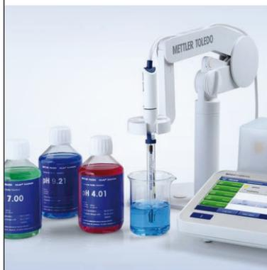
El uso de los métodos es una forma segura y eficaz de calibrar un sensor de pH. Una vez que se ha creado un método, se usa la misma configuración en cada calibración. Los límites de offset y pendiente pueden controlarse para prevenir que se guarde una calibración deficiente.
