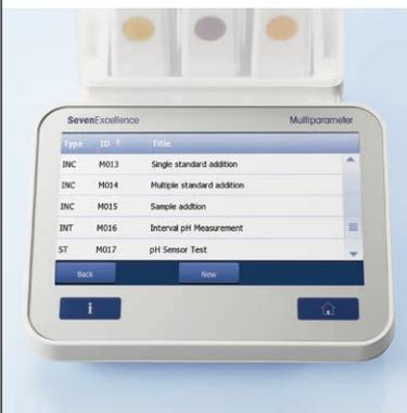
Se incluyen los métodos especiales para las técnicas de medición de concentraciones de iones incrementales más frecuentes, como los métodos de adición/sustracción de diversos estándares y adición/sustracción de muestras. Así dispone de una herramienta flexible y moderna para las mediciones de concentraciones de iones profesionales.
