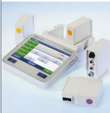
En SevenExcellence se pueden conectar tres módulos en cualquier composición y orden. Ofrece la mayor flexibilidad posible, ya que puede ampliar el instrumento en cualquier momento añadiendo nuevos parámetros de medición.
