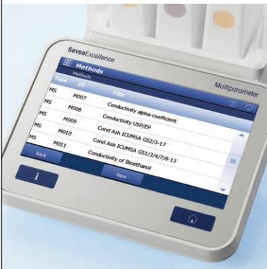
Además de ser más seguros, más reproducibles debido a la configuración idéntica y más cómodos, los métodos también le permiten ejecutar aplicaciones especiales para conductividad. Entre estas se incluye la medición de USP/EP del agua pura con control de los límites y mediciones de las cenizas de conductividad de acuerdo con dos normativas de la ICUMSA.
