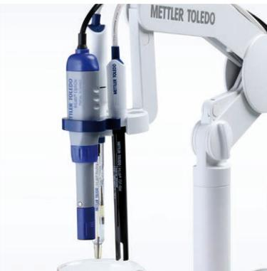
SevenExcellence permite las mediciones simultáneas de 1, 2 o 3 parámetros, ya sea en la misma o en diferentes muestras. Con las mediciones multicanal se puede usar la señal de temperatura de un módulo con todos los demás, a fin de garantizar que las lecturas de temperatura sean idénticas.
