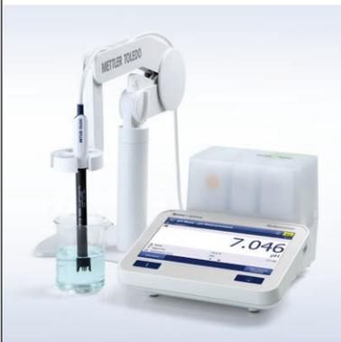
uPlace™: el brazo portaelectrodos con un movimiento totalmente vertical que puede usarse con solo una mano. De este modo, se pueden realizar mediciones más rápidas y reducir el riesgo de que el recipiente de muestras vuelque o dañe el sensor.
