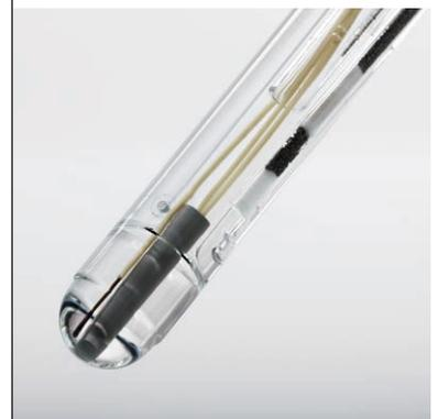
SevenExcellence ofrece la posibilidad de comprobar las prestaciones de un sensor de pH. El test de sensor del tipo de método especial guía al usuario por cada paso, comprobando diferentes características de medición de un sensor, como la deriva y la repetibilidad.
