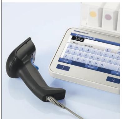
La introducción de texto, por ejemplo ID de muestras, se ha convertido en una tarea rápida y cómoda mediante la pantalla táctil del instrumento. Para mejorar aún más la eficiencia, puede usar un lector de códigos de barras USB.
