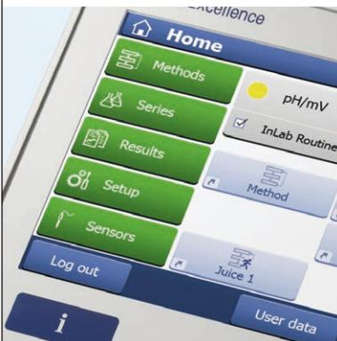
Para iniciar una serie o un método, basta con hacer clic en un acceso rápido. Si se inicia cuando se está ejecutando, el análisis siguiente se pone en cola de espera en la lista de tareas y se inicia automáticamente una vez terminada la tarea anterior.
