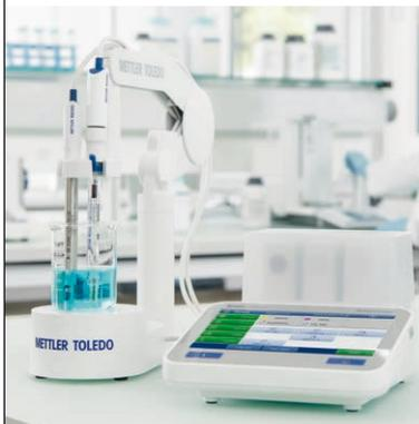
El agitador magnético uMix™ opcional de METTLER TOLEDO ofrece un nivel superior de flexibilidad para los métodos. La agitación puede ajustarse de forma individual para los pasos de medición o espera de su método y la velocidad de agitación puede definirse en función del tamaño del recipiente y la viscosidad de la muestra.
