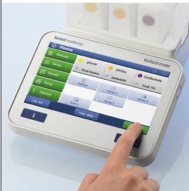
Este instrumento incorpora una segunda posibilidad para iniciar una medición o calibración pulsando READ o CAL. Aunque es más flexible, la realización de mediciones directas de forma consecutiva con diferentes parámetros hace necesario el cambio de configuración antes de cada muestra.
